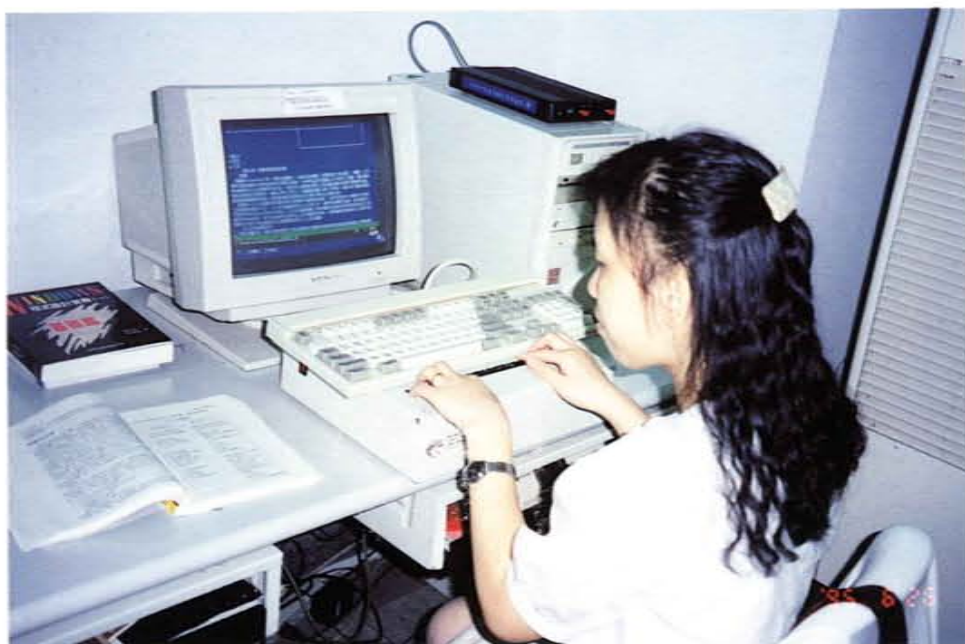
點字觸摸顯示器接上個人電腦後之使用情形
